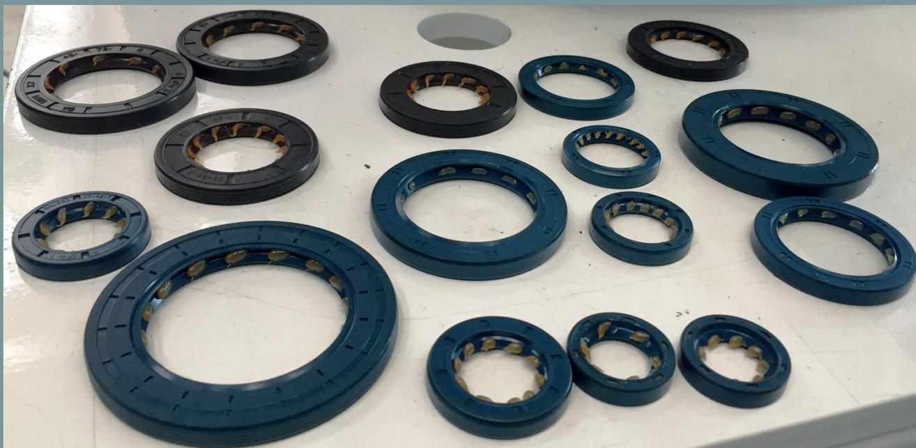
Gli anelli comunemente utilizzati nella costruzione di motoriduttori sono in gomma e per aumentarne la durata è necessario apporre del grasso sull'anello interno in modo che la zona di contatto con l'albero rotante sia lubrificata.
