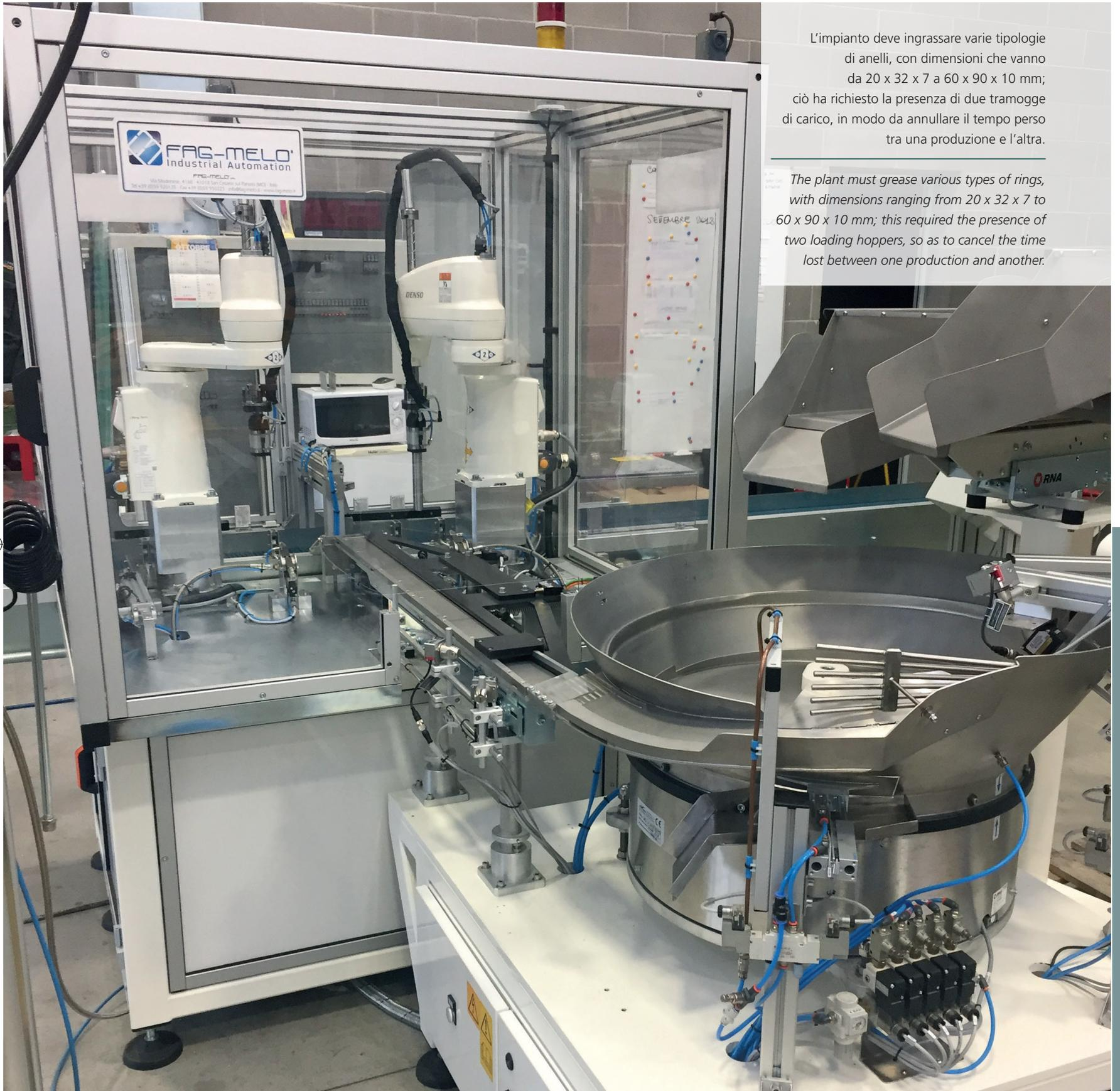
L'impianto deve ingrassare varie tipologie di anelli, con dimensioni che vanno da 20 x 32 x 7 a 60 x 90 x 10 mm; ciò ha richiesto la presenza di due tramogge di carico, in modo da annullare il tempo perso tra una produzione e l'altra.
